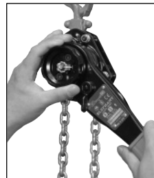
5) Paina syöttökahvaa varovasti alas ja vedä alakoukku käyttökahvalla.
