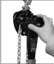
2) Käännä syöttökahvaa puoli kierrosta vastapäivään. Tämän jälkeen vapaakelaus on käytettävissä automaattisesti.
